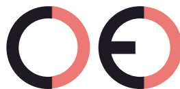
Falsche CE-Kennzeichnung (zu großer Zwischenraum)
